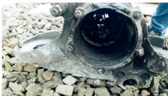
Fig. 2, 3, 4 – La causa primaria del deragliamento: rottura del fusello dell’asse della carrozza 6
